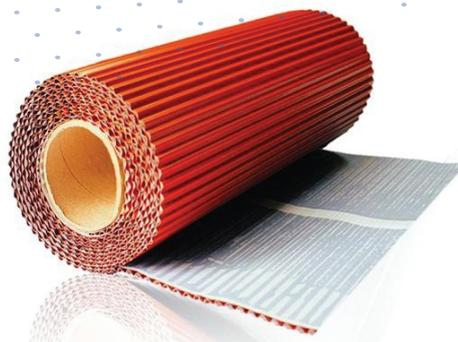
**VesiEste F1 AlumForm** – это самоклеющаяся лента, используемая для уплотнения и обработки кровельных покрытий. Благодаря сильно плиссированной поверхности продукта (130%), достигается очень высокая пластичность и растяжимость ленты. Изготовлена из лакированного алюминия с УФ-стабилизирующими добавками, обладает большой устойчивостью к воздействию атмосферных факторов.
